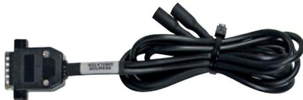
Câblage d'émulation, avec la fonction de simulateur numérique de résistance variable d'environ 100 à environ 25.000 pour la simulation de capteurs (ex: capteur de température moteur, etc...).
