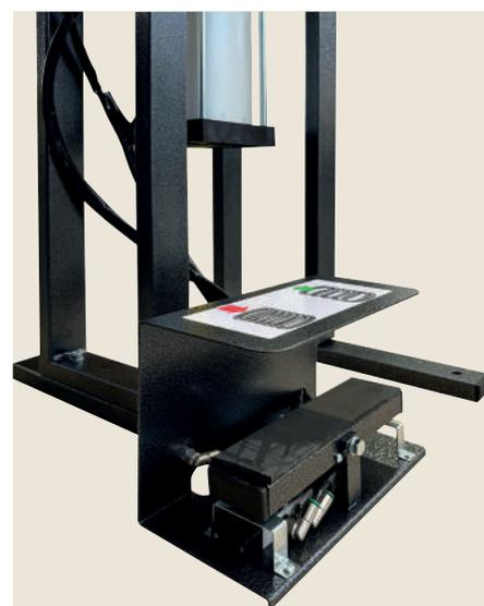
**LE PÉDALE DE COMMANDE FONCTIONNE SEULEMENT SI LA MACHINE EST BRANCHÉE À L'AIR COMPRIMÉ**
