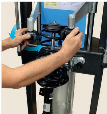
**ÉTAUX SUPÉRIEURS FLOTTANTS**, pour une meilleure fixation sur le ressort, avec adaptation dynamique également durant les différentes phases de compression
