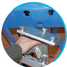
Étau de blocage, pour tiges amortisseurs (la partie hydraulique de l'amortisseur) Ø40 - 60 mm
