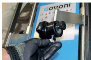
Les goupilles évitent l'utilisation de la vis M8 fournie avec l'extracteur d'amortisseur, et de la clé hexagonale correspondante pour les retirer.
