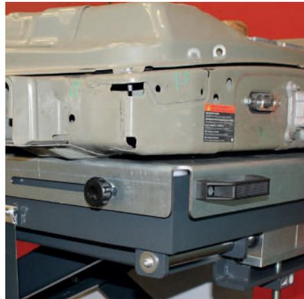
LE PLATEAU SE DÉPLOIE AVEC POIGNÉE ET VOLANTS DE RÉGLAGE
