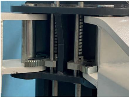
**ARRÊT DES BRAS À ENCLÈCHEMENT AUTOMATIQUE ET DÉCROCHAGE AUTOMATIQUE EN POSITION BASSE**
