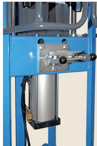
**CYLINDRE EN ALLIAGE LÉGER D'ALUMINIUM**, résine de nylon et fibre de verre pour combattre la corrosion et l'oxydation.
