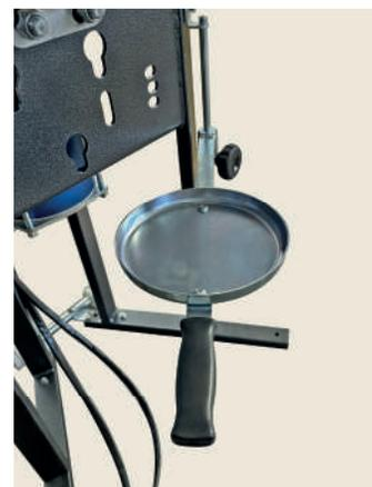
**SUPPORT ANTICHUTE** pour aider démontage/montage tige amortisseur
