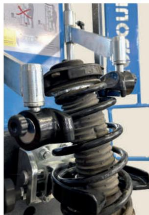
**ÉTAUX SUPÉRIEURS FLOTTANTS** pour une meilleure fixation sur le ressort, avec adaptation dynamique également durant les différentes phases de compression.
